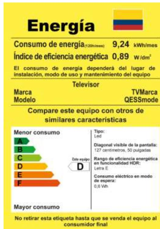
Figura 7.13.5.a. Ejemplo de etiqueta para Televisores
