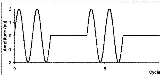
**c) Corriente de prueba de armónicos, cero corrientes durante ángulos de fase entre 0-90° y 180-270°**
