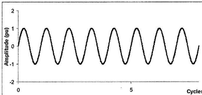
**b) Corriente de prueba de subarmónicos, 2 ciclos encendidos, 2 ciclos apagada**
